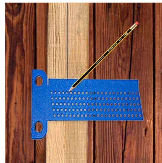
Hvis ikke det findes, så må man printe det selv! Frederik brugte Træværkstedets 3D printer til at lave et værktøj, der gør det muligt at sætte præcise afmærkninger i en fart.
